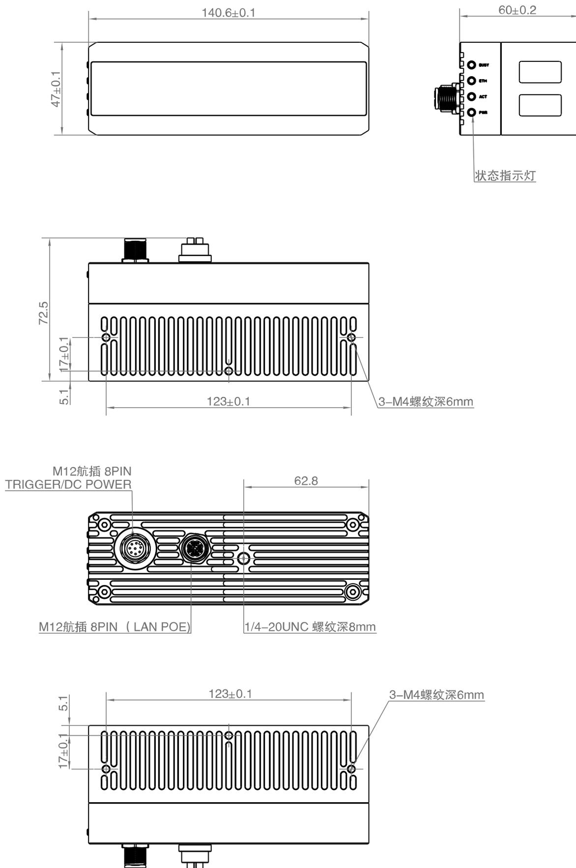
图 4 PS800-E1 尺寸图 (单位: mm)
