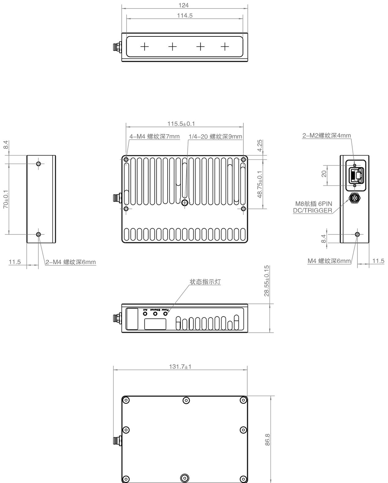
图 4 FM850-E2 尺寸图 (单位: mm)
